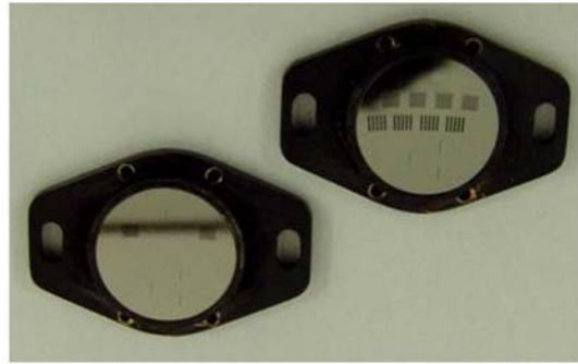
图 6 指示光栅的实物照片
