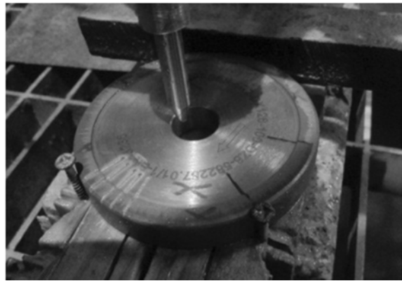
图 3 被修锐的金属结合剂金刚石砂轮
