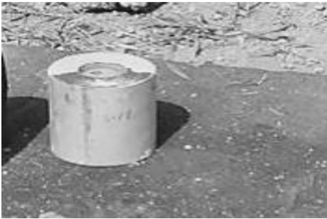
图1 试验 TNT 炸药柱
