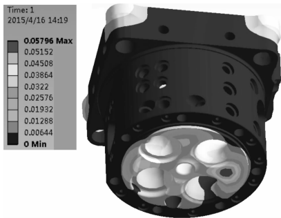
图 11 缸盖在机械载荷下的变形量
