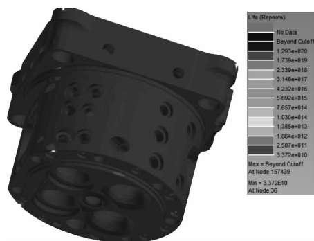
图 15 缸盖结构的疲劳寿命云图
