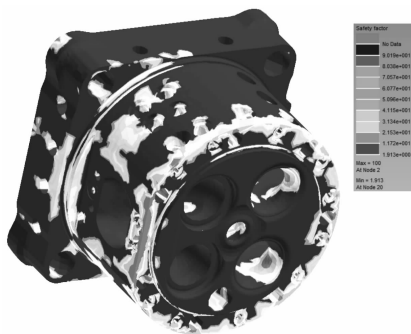
图 14 缸盖结构的疲劳安全系数云图
