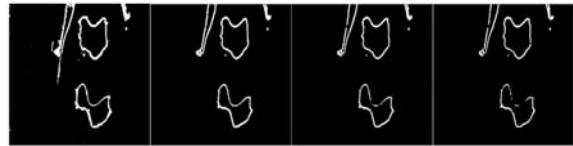
图 5 阈值不断增大得到的边缘图像
