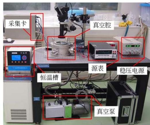
图 9 微热管测试系统实物图
