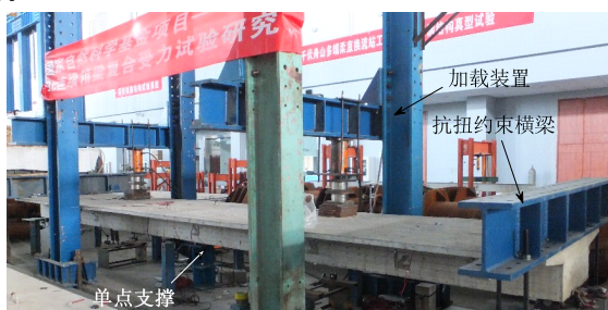
图 4 典型箱梁构件加载照片
