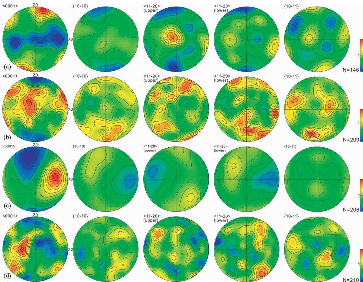
图5 北秦岭造山带主要韧性剪切带变形岩石石英 EBSD 结构图(样品位置见图 1)
