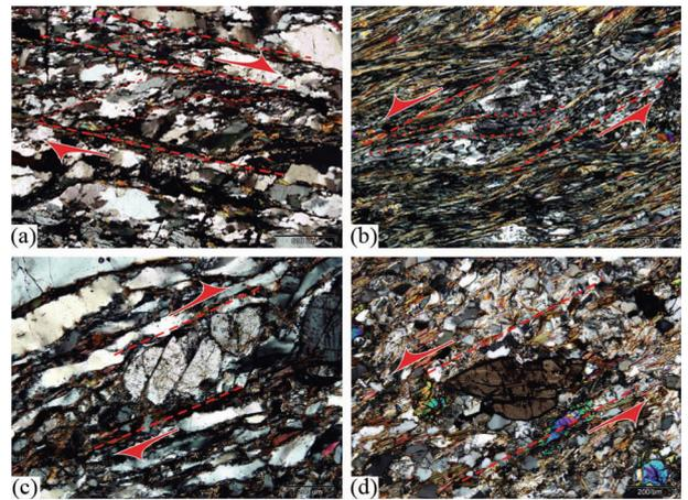
图4 北秦岭造山带主要剪切带显微韧性变形特征
