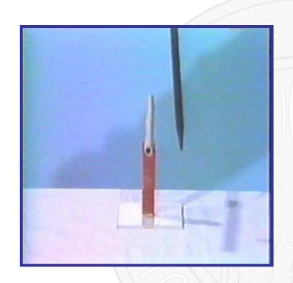
公元前6世纪希腊学者泰勒斯 发现了摩擦起电的现象。用毛皮 摩擦过的橡胶棒带负电,用丝绸 摩擦过的玻璃棒带正电。
