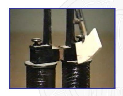
本视频介绍电磁阻尼摆原理。当金属摆进出两铁芯形成的磁场空间时,因超过金属板磁通量的变化,在摆中形成强电流。此电流或场作用将阻碍摆的进出,从而形成阻尼。
