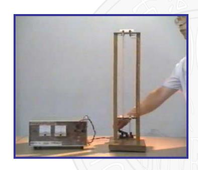
两平行直导线中通以电流 时,两导线间有相互作用力。当 电流方向相同时,两导线相互吸 引;当电流方向相反时,两导线 互相排斥。
