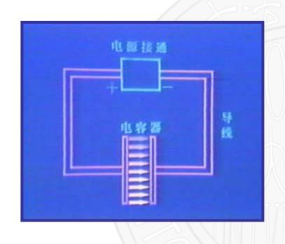
位移电流 本视频介绍位 移电流概念,当RC电路由 直流电源充电时,导线中 有传导电流, 电容器极板 间无传导电流, 灯泡仍然 瞬间发光,放电时也是如 此。若采用交流电源,则 灯泡始终发光。麦克斯韦 把电容器中变化的电场定 义为位移电流。
