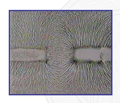
引入磁感应线的概念可形象 描绘磁场在空间的分布情况。磁 感应线的方向代表了磁场的方 向;磁感应线的密度代表了磁场 的强度。
