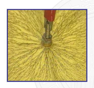
利用电场线的概念可形象描 绘电场在空间的分布情况。电场 线的方向代表了电场的方向;电 场线的密度代表了电场的强度。
