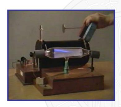
磁场中的运动电荷会受到磁力的作用,这种作用力称为洛仑兹力。洛仑兹力的大小和方向与磁场的大小、方向以及运动电荷的速度都有关。
