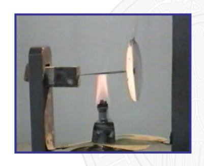
本实验介绍居里点 某磁针 吸附在铁芯上。当被加热到一定温度时,磁针与铁芯分 离了。说明达到这个温度 时,磁针由铁磁介质变成顺 磁介质,同时磁性消失。这个温度就是居里点。
