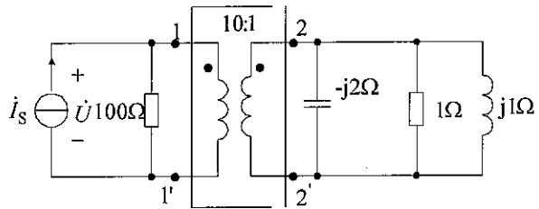
应用理想变压器变换阻抗的性质，可得初级的等效电路
