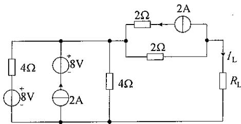
三、电路如图所示, 试求 3 个电流源的电压  $U_{14}$ 、 $U_{24}$  和  $U_{23}$ 。(15 分)
