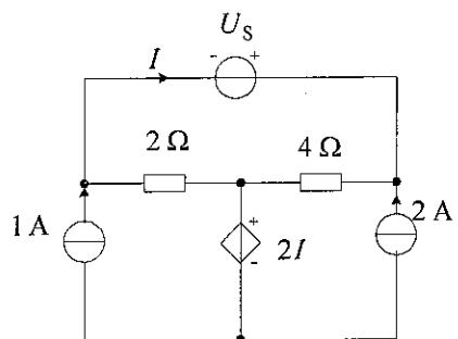
六、电路如图所示, 当  $t=0$  时开关闭合。闭合前电路已达稳态。
