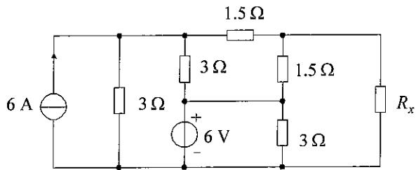
先求出关于  $R_x$  的戴维南等效电路
