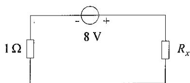
$$R_x = R_o = 1 \Omega \text{ 可获得最大功率} \quad 8$$
