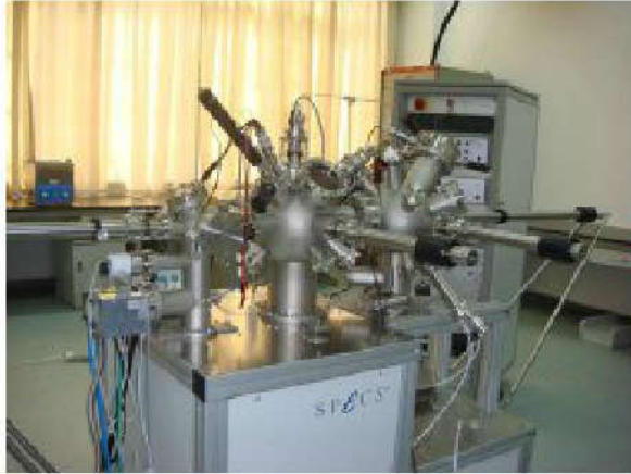
图16 扫描隧道显微镜及其原理
