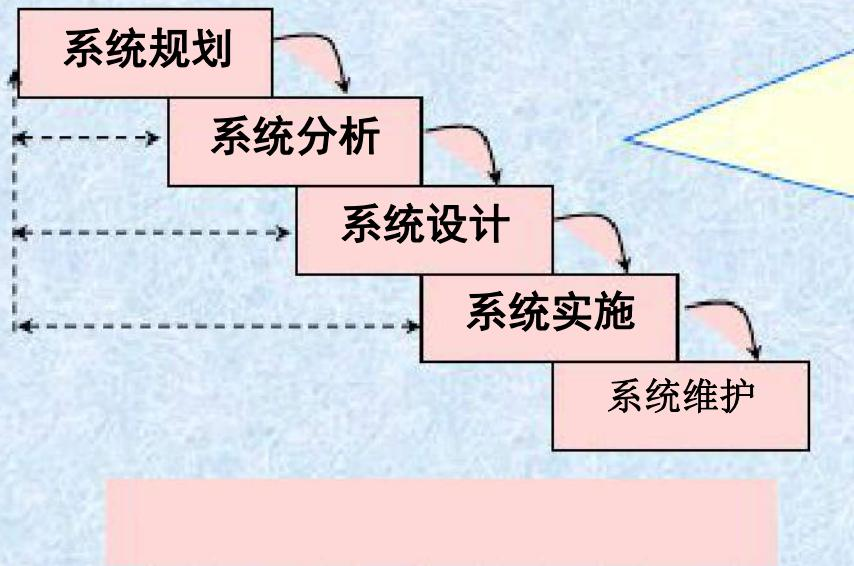
每一个阶段都有明确的工程任务并产生规范的文档资料，且必须评审。用以及时发现错误，防止将错误蔓延到后续阶段，避免重大损失。
