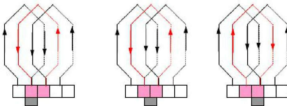
电枢旋转时，被电刷短路的元件从短路开始到短路结束，
