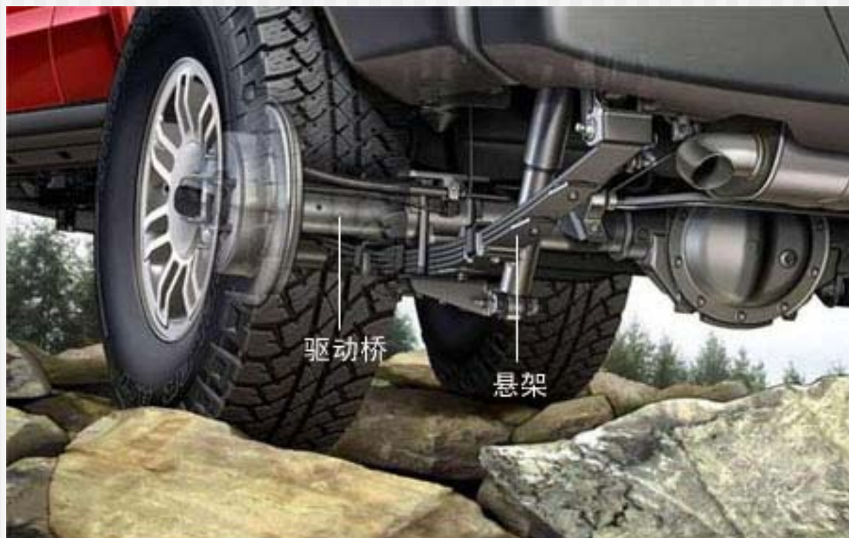
汽车驱动桥与悬架的关系
