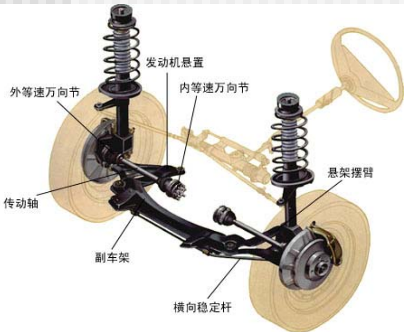
上海桑塔纳轿车前桥（转向驱动桥）
