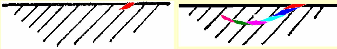
裂纹返向表面 ⇒ 微粒材料脱落且表面形成麻点；
