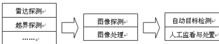
图 2 光电探测智能联动的基本方式
