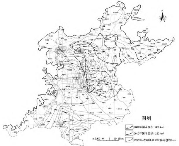
图 1 北京平原主要开采层 2001 和 2010 年地下水漏斗和 1955 年-2009 年地面沉降分布对比
