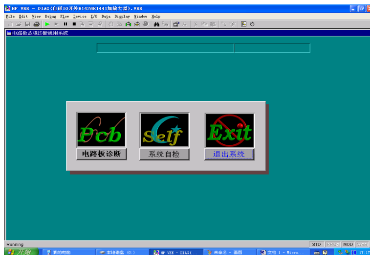
图2 基于 VXI 总线的某型设备故障诊断专家系统开发平台界面
