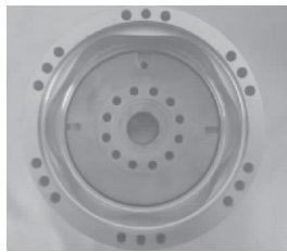
图 18 低速大扭矩水压马达配流体定子部分
