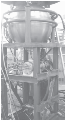
图 17 超高压海水泵压力筒试验
