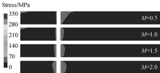
图 11 不同吹风比时子午面的应力云图 ( $\alpha=90^\circ$ )
