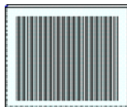
机制光栅:玻璃片上刻划出一系列平行等距的划痕
