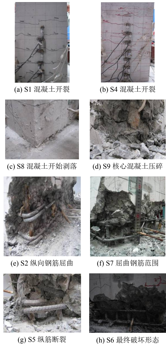
图 9 桥墩试件损伤状态
