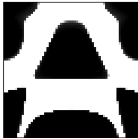
图 5 阻尼材料层拓扑优化结果
