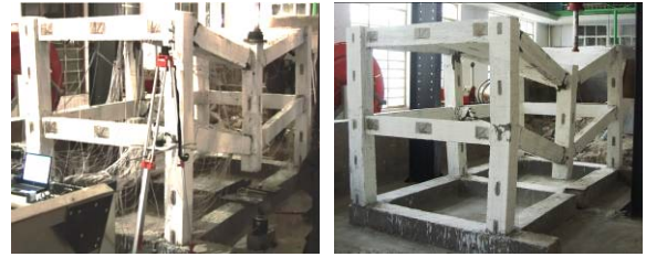
D=1.000 (倒塌破坏点)
