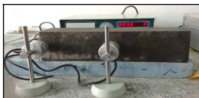
图 4 试件动弹性模量测定
