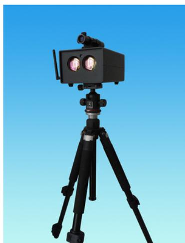
本系统已经经过田径运动的训练试用。是适用于体育训练、科研与教学的专业直线运动测速系统。系统可以 100Hz/50Hz 频率测量 150 米范围内直线运动速度，速度测量精度达到 0.1 米/秒，可在运动现场得到速度与时间、速度与距离、距离与时间曲线，以及定量数据，可以作分段距离间隔标记。可用于短跑、跨栏、跳远助跑、三级跳助跑、撑杆跳助跑等项目的训练指导、科学研究以及教学。系统数据采集与分析软件为全中文界面。数据传输采用无线方式，使用操作简单易行，数据精确可靠，便于统计与分析。非常适合于体育训练、科研、教学，也适合车辆等物体的直线运动测速用途。
