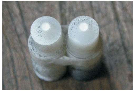
图 14 PA66 试样拉伸后断口形态
