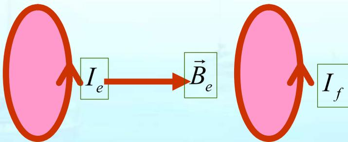
磁场作用电流使之运动时会产生感应电动势，使两个线圈的电流发生改变
