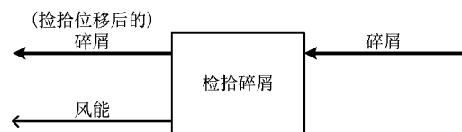
图1 手提式吸尘器倒逼黑箱模型
