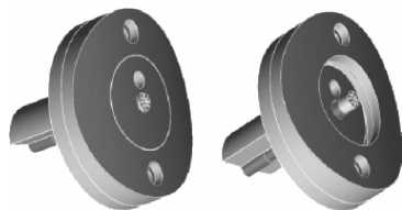
图 5 噪声传感器安装方法
