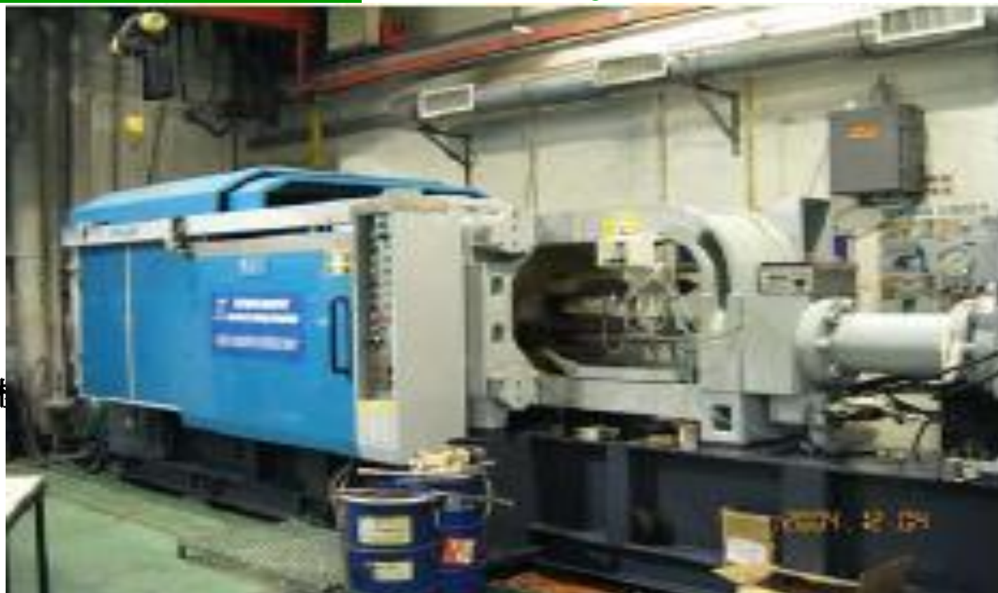
Semi Solid Metal Forming facility in HKPC 生產力局的 SSM 壓鑄機
