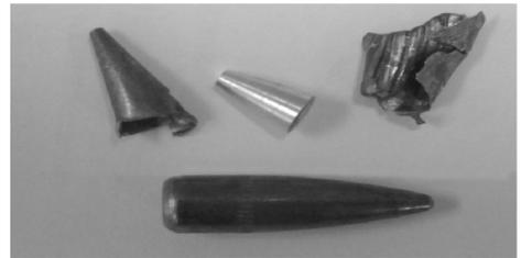
图 10 弹头破碎图
