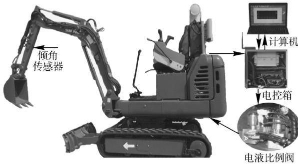
图 1 电液控制挖掘机
