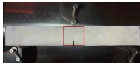
图 3 单边切口小梁断裂试验
