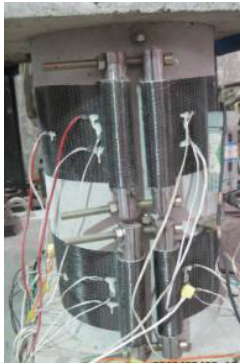
图 2 碳纤维布预应力施加方法 Fig.2 Lateral pre-stressing method of CFRP
