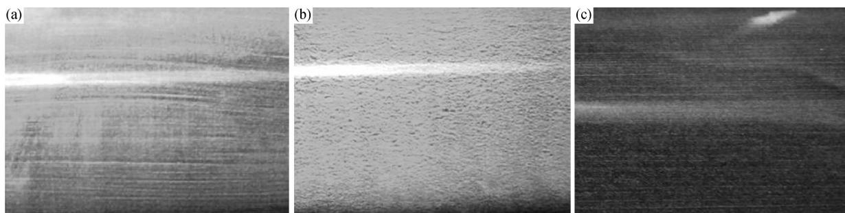
图1 三种类型磁痕显示 (a)长条状;(b)片状;(c)长直状
