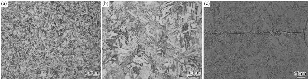
图7 固溶热处理后1<sup>#</sup>(a)、2<sup>#</sup>(b)和3<sup>#</sup>(c)试样的金相照片
