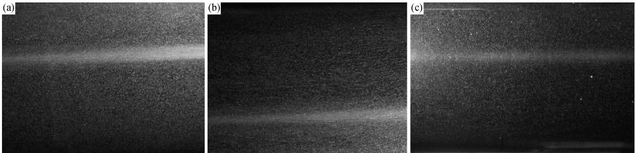
图8 时效热处理后1<sup>#</sup>(a)、2<sup>#</sup>(b)和3<sup>#</sup>(c)试样磁粉检测结果
