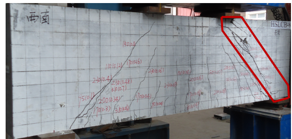
(b) 试件 HSLCB-8 破坏形态
