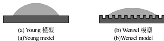
图 6 液滴在基板上的润湿模型
