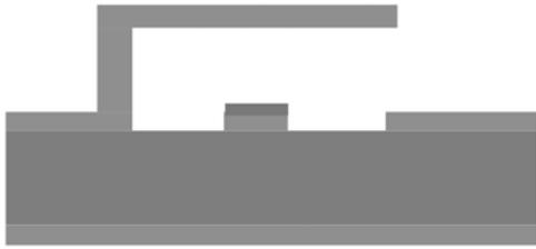
图 2 悬臂梁开关结构
