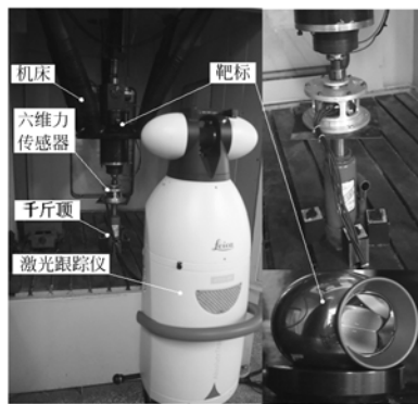
图 8 机床刚度测量实验
