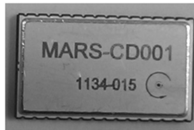
图 17 集成 ASIC 电路的圆片级封装 MEMS 陀螺, 尺寸为 11.5 \text{ mm} \times 19.5 \text{ mm}
