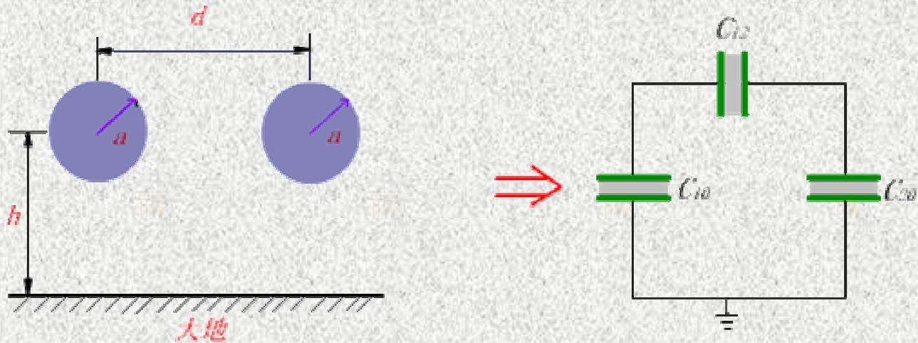
图2.8.5 两线输电线及其电容网络
