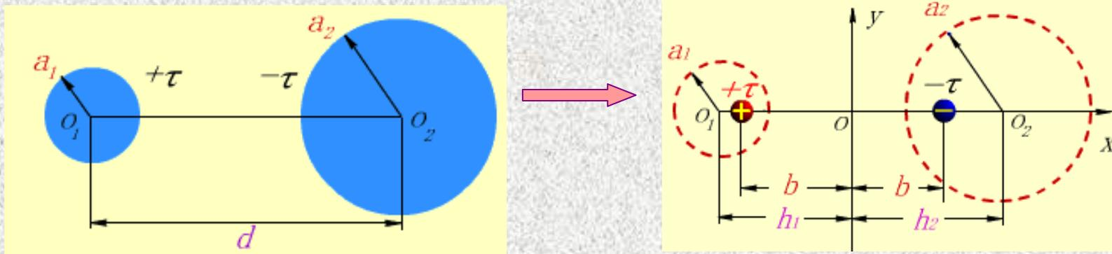
图1.7.16 不同半径传输线的电轴位置
