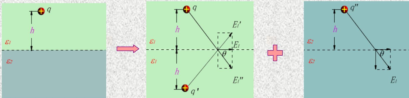
图1.7.9 点电荷对无限大介质分界面的镜像
