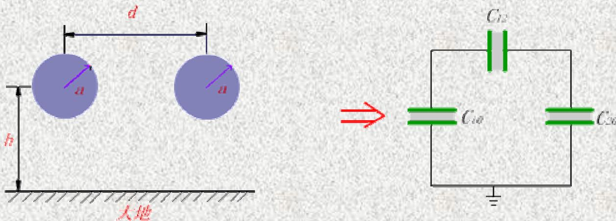
图2.8.3 两线输电线及其电容网络
