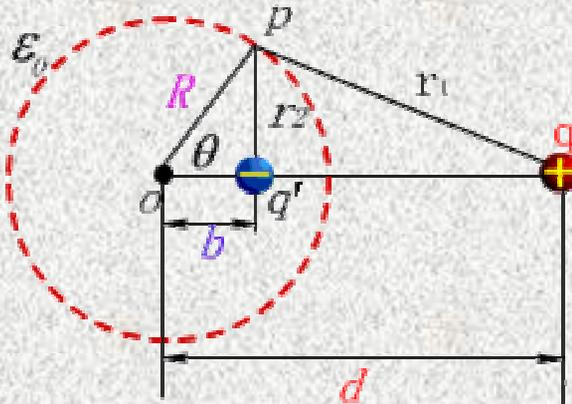
图1.7.3 点电荷对接地导体球面的镜像
