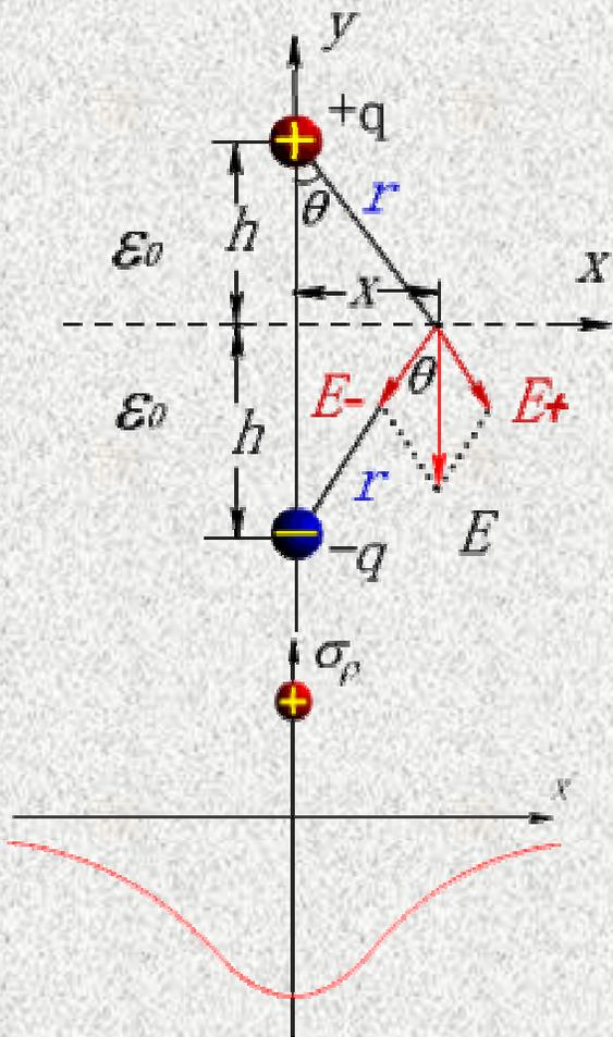
图1.7.2 点电荷 在地面引起的感应电荷的分布
