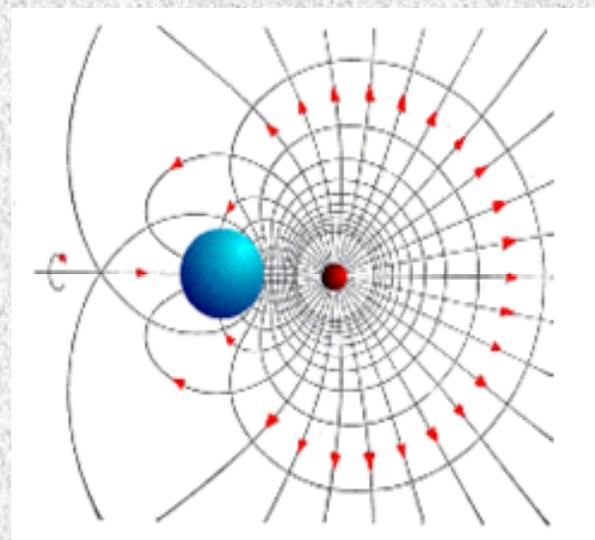
图1.7.5 点电荷位于接地导体球附近的场图
