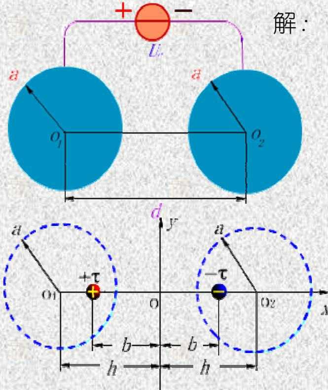
图1.7.18 电压为 $U_0$ 的传输线电场的计算
