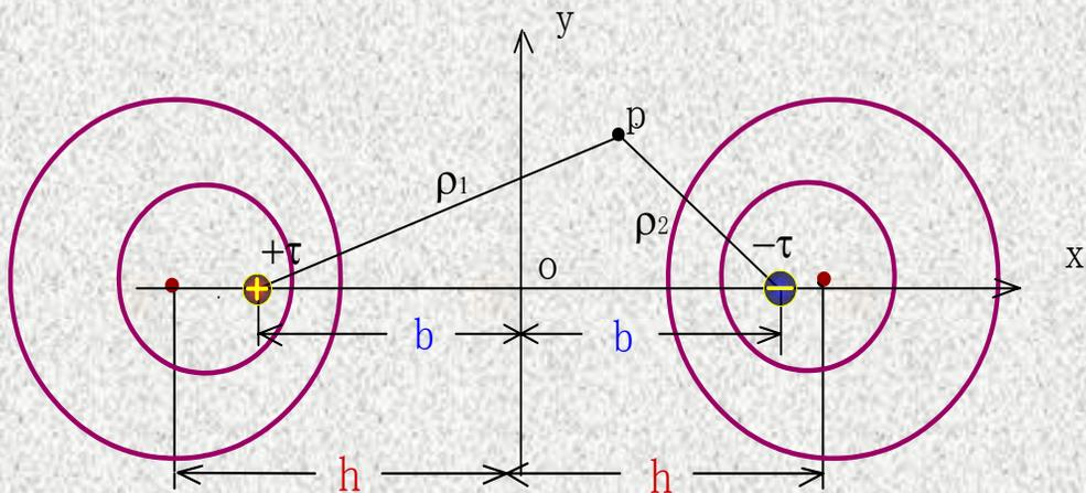
图1.7.13 两根细导线的电场计算
