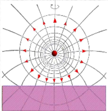
图1.7.10 点电荷 位于不同介质平面上方的场图
