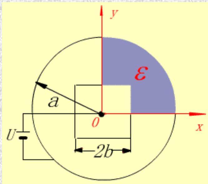
图 2.6.4 缆心为正方形的同轴电缆横截面
