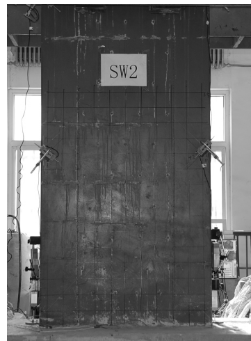
(c) 1/100 位移角时试件照片
