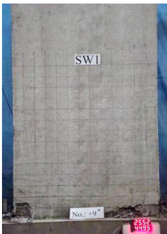
(c) 1/100 位移角时试件照片
