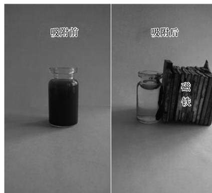
图 5 磁性埃洛石的外磁场作用图
