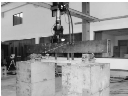
图10 静载试验的加载方式
