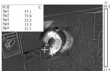
图 3 66 式 152 mm 弹丸剪切断面温度分布
