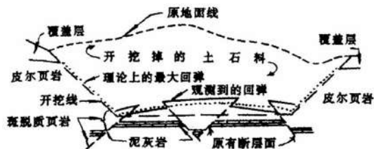
图2-28 俄亥坝静水池基坑开挖过程中岩体的变形、破坏情况示意图
