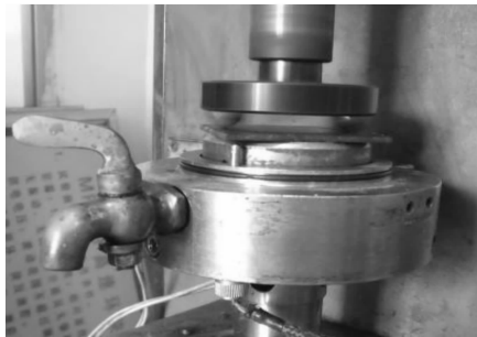
图 7 实验试件的装夹
