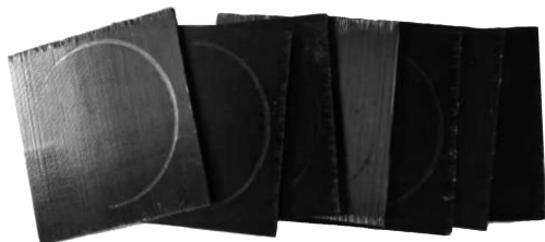
图 8 磨损后的嵌入式共固化复合材料试件
