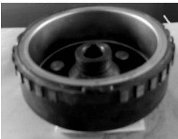
图3 壳体上再压焊一齿圈
